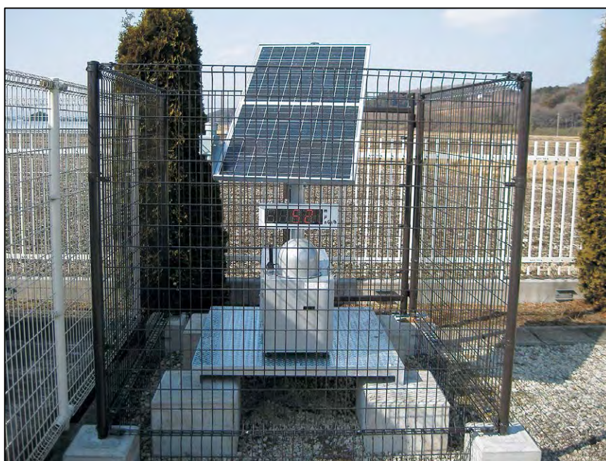
【たひよう保育園に設置した空間放射線量モニタリングポスト】
