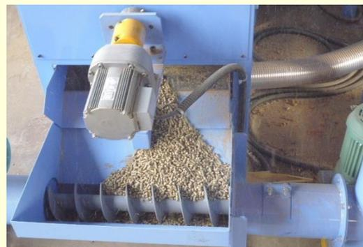
エリアンサスからペレットの製造工程
