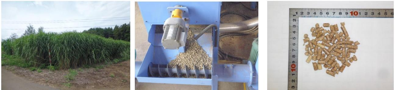
【バイオマス資源作物（エリアンサス）の栽培とエリアンサスペレットの製造】
