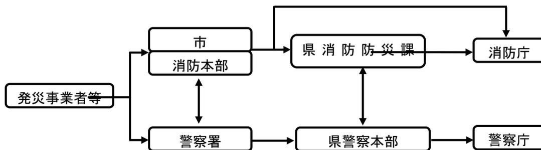
9 高圧ガス事故災害情報の収集・伝達系統
