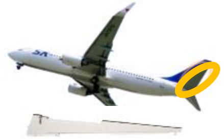
航空機複合材部品 (B737昇降舵の外板)
