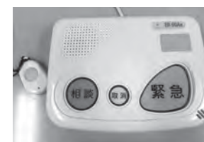
緊急通報装置
