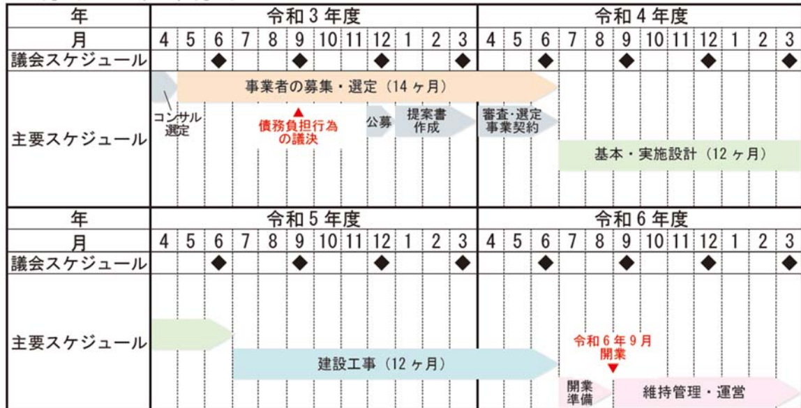
DBO方式・PFI(BTO)方式（設計・建設・維持管理・運営 一括発注）
