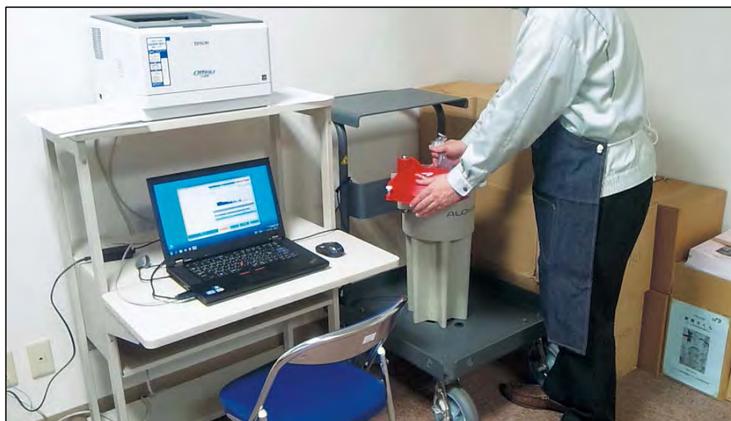
【喜連川支所に設置した食品放射能測定システム】
